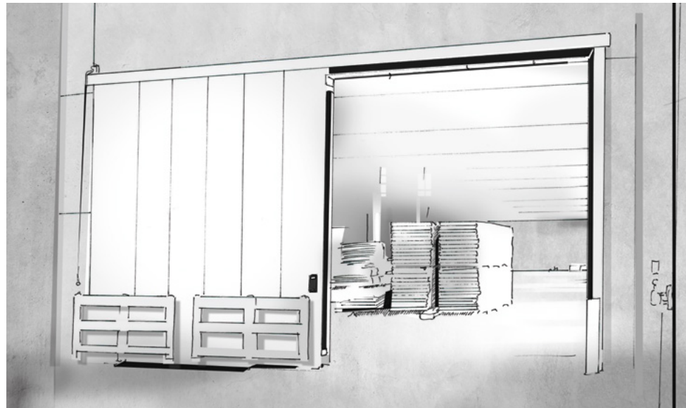
Beispielhaftes Brandschutztor, das als Schleuse zwischen zwei Brandabschnitten dient.
