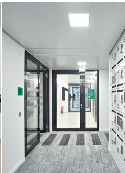
Rohrrahmentür mit feststehendem Lichtflügel.
