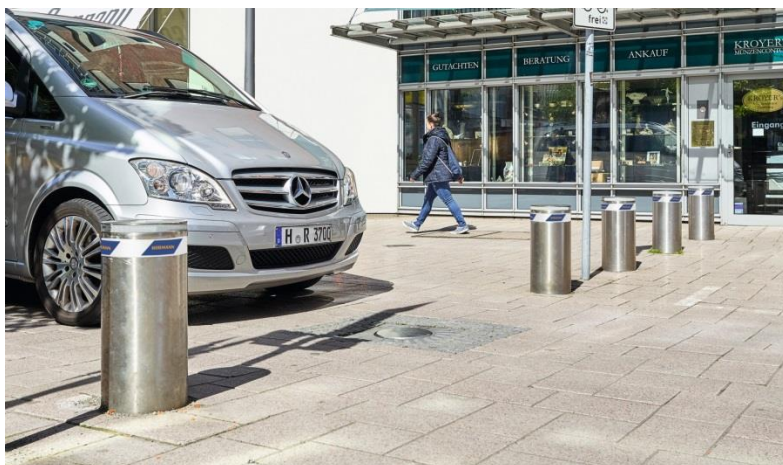
Fot. 2: Podnoszone i opuszczane hydraulicznie lub elektromechanicznie słupki firmy Hörmann pełnią funkcję kontroli dostępu w obiektach prywatnych i użyteczności publicznej.
