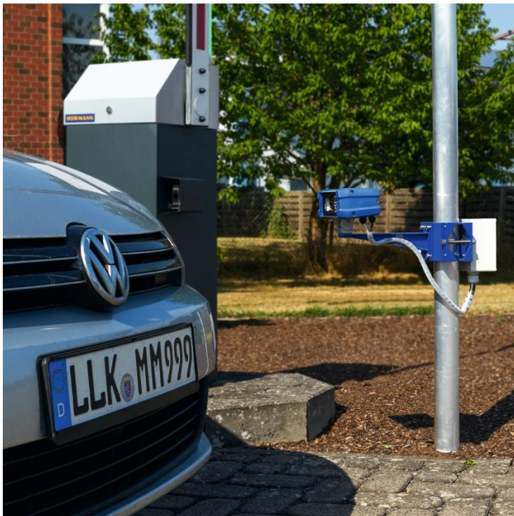
Bild 5: Bei der Nummernschilderkennung scannt eine Kamera das Nummernschild des Fahrzeugs, das zuvor im Ausweismanagement-System freigeschaltet werden muss.
