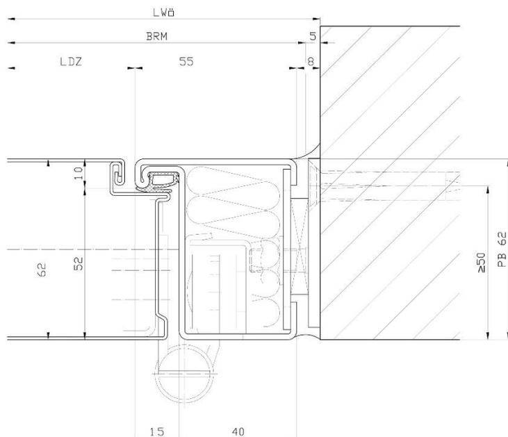
**Bild 3:** Da die DryTec Blockzarge 62/55 bzw. 62/75 über die gleiche Stärke wie das stumpf einschlagende STS-Türblatt von Hörmann verfügt, wird eine beidseitige Flächenbündigkeit erreicht.
