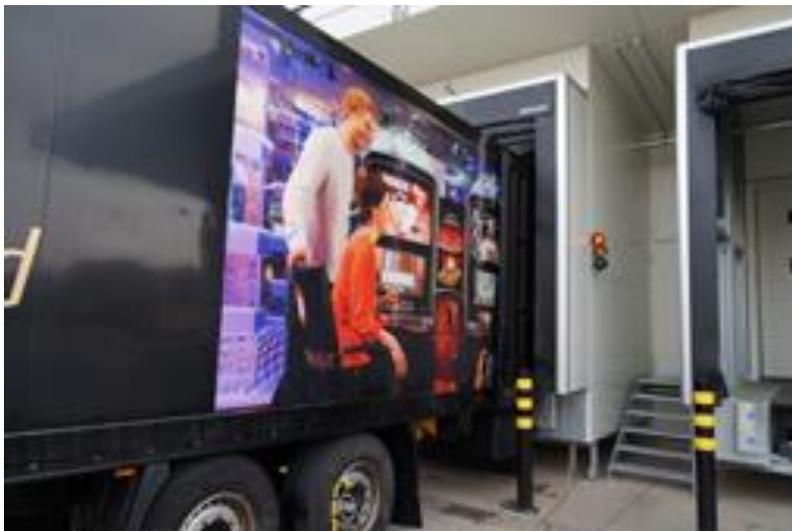
**Bild 7:** Der Hörmann Andock-Assistent HDA-Pro unterstützt den Fahrer beim sicheren Heranfahren an die Rampe. Sensoren im Torblatt erkennen die Entfernung des Fahrzeugs und eine Ampel signalisiert dem Fahrer, ob er bereits an der richtigen Position steht.
