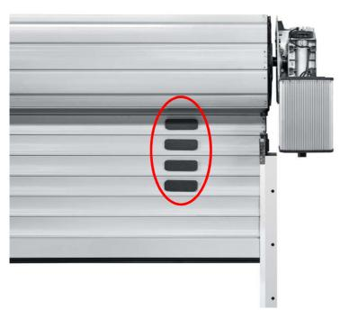
**Bild 3:** Das Hörmann Rolltor DD S6 ist serienmäßig mit so genannten L-Pads auf der Torbehang-Innenseite ausgestattet, die das Laufgeräusch und den Verschleiß an den Lamellen reduzieren.
