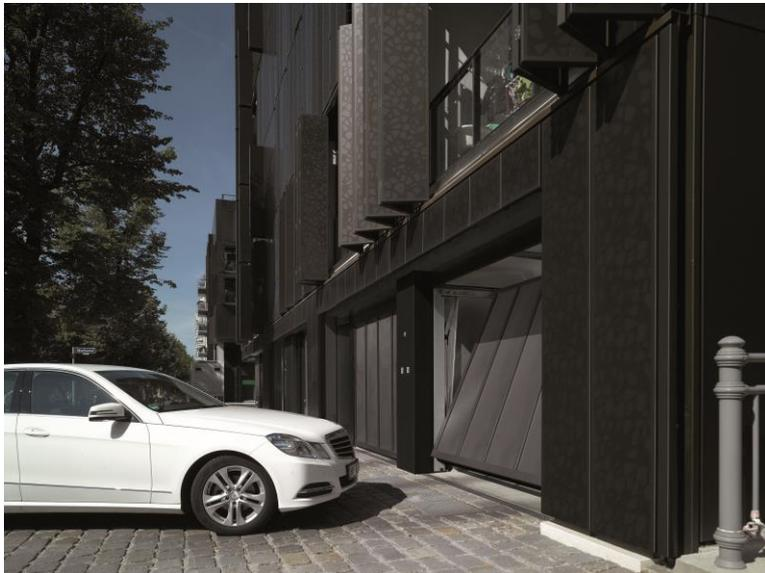
**Bild 1:** Das Kipptor ET 500 eignet sich besonders zum Einsatz bei Sammelgaragen an hochfrequentierten Gehwegen. Der Torflügel schwenkt bei Einbau hinter der Öffnung nicht aus und lässt damit Passanten genügend Platz ohne sie zu behindern oder zu gefährden.
