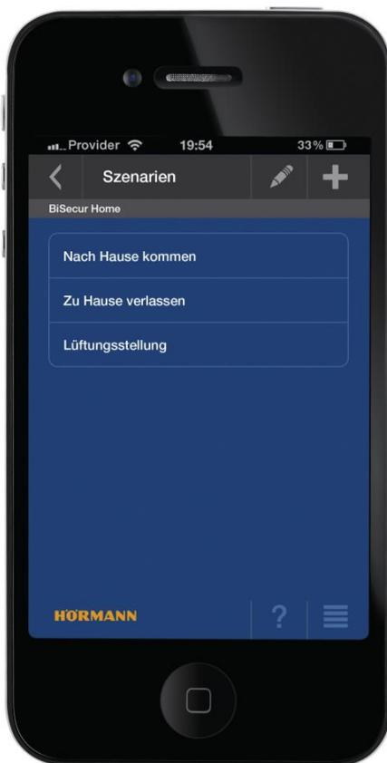
**Bild 4:** Für wiederkehrende Situationen wie das „nach Hause kommen“, in denen beispielsweise zunächst das Einfahrtstor aufgefahen und danach das Garagentor geöffnet werden soll, kann in der Hörmann App ein so genanntes „Szenario“ erstellt werden. Auf nur einen Tastendruck werden immer dieselben Aktionen automatisch ausgeführt anstatt einzeln angewählt werden zu müssen.
