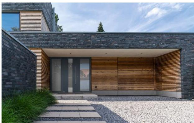
Porte d'entrée en aluminium ThermoCarbon, motif 680, gris ardoise RAL 7015, structure fine mate
