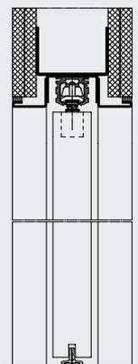
// NEU: Schiebetürzarge HW-SL, Kastenbauweise ohne Blende
