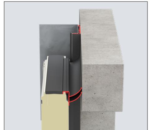
Hochwertige Dichtungen reduzieren die Wärmeverluste. Sie erhalten eine nochmal bis zu 21 % bessere Wärmedämmung mit dem optionalen **ThermoFrame Zargenanschluss**, der die Zarge und das Mauerwerk thermisch voneinander trennt.
