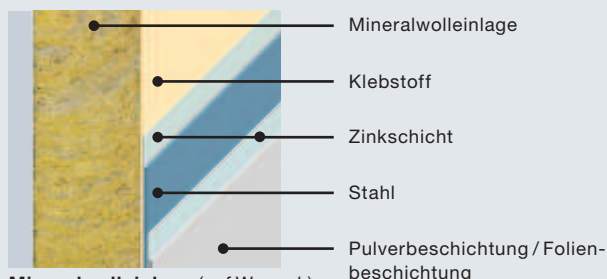
Mineralwolleinlage (auf Wunsch) für bessere Wärmedämmung
