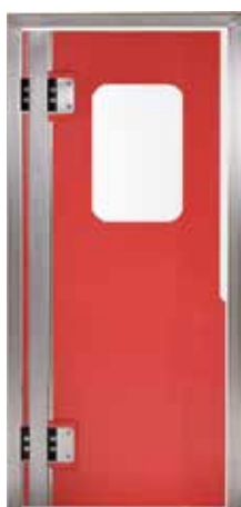
1křídlé provedení Úhel otevření 2 × 180° Šířka v mm: 550 – 1600 Výška v mm: 1800 – 4600
