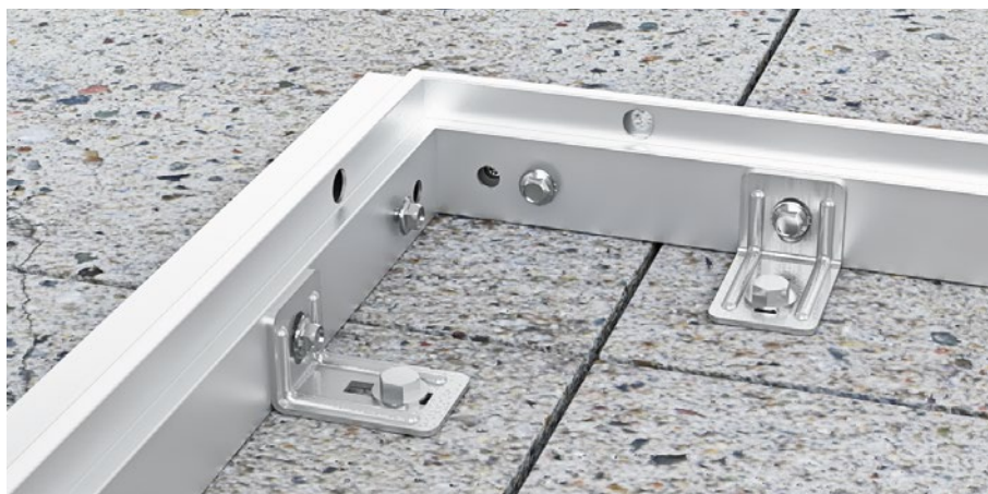
Upevnění hliníkového profilu podlahového rámu Berry na dlažebních deskách (příklad ukotvení)
