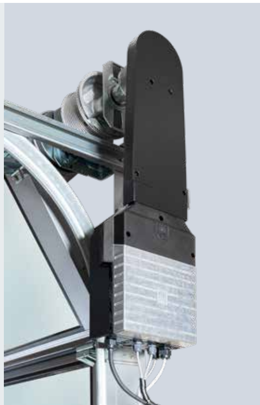
Automatismo WA 300 S4 con máx. 150 ciclos (abrir / cerrar) al día o bien máx. 10 ciclos (abrir/cerrar) en una hora
