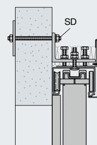
Isključivo u kombinaciji s nadvojem od čeličnog betona, prema statičkom nacrtu.
