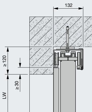
**Direktna montaža na strop s plastičnim nosačem**
