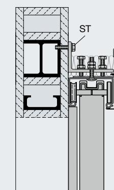
Obloženi čelični stupovi i / ili nosači čija je minimalna klasa zaštite od požara F90,
