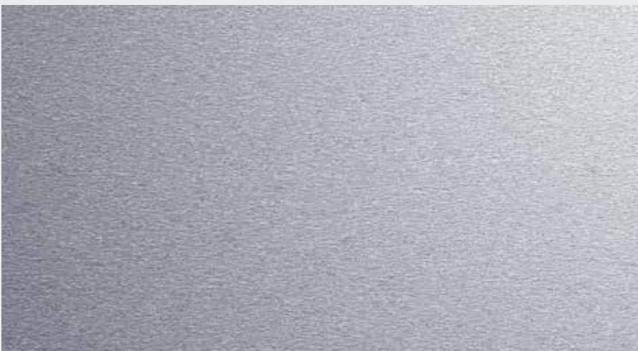
Rustfrit stål V2 A, 1.4301, K 240
