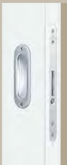
Bij in de wand lopende schuifdeuren kunt u met een springgreep een deurblad dat geheel in de wand is geschoven er met een druk op de knop weer uittrekken en de deur sluiten.
