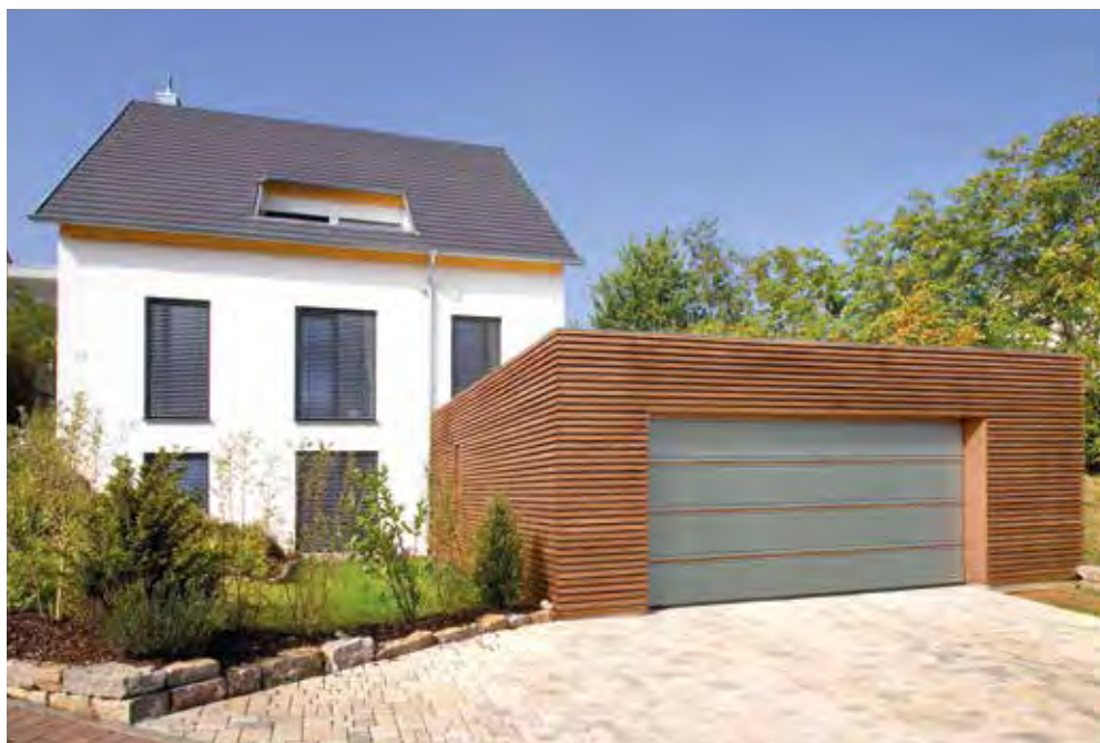
▲ Brama z przetłoczeniami T i powierzchnią Silkgrain w kolorze RAL 7030 (szary), wzór 501, z intarsjami imitującymi drewno umieszczonymi na całej szerokości bramy
