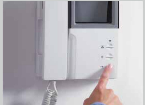
S5 / S7 Comfort – Ouverture de la porte par pression sur une touche
