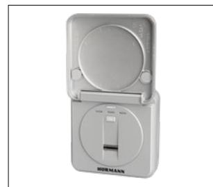
Bezdrátová čtečka otisku prstu FFL 25 BS 2 funkce, až 25 otisků prstů, s odklápěcí krytkou, možnost montáže pod omítku a na omítku, umělohmotná skříň lakovaná v barvě bílý hliník RAL 9006
