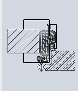
Einbau in eine Wand mit geringer Wandstärke bis 50 kg Türblattgewicht
