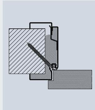
Einbau in Mauerwerk mit Schrägbefestigung bis Türblattgewicht 120 kg
