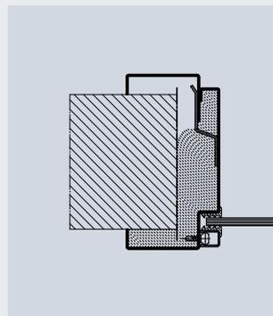
Einbau in Mauerwerk mit einseitiger Schallschutzverglasung
