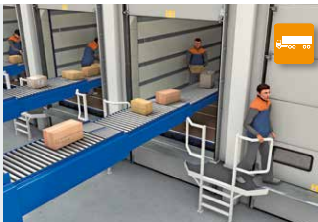
Vid lastning av lastbilar och växelflak stannar bottensektionen med manöversteget kvar vid golvytan när porten öppnas.
