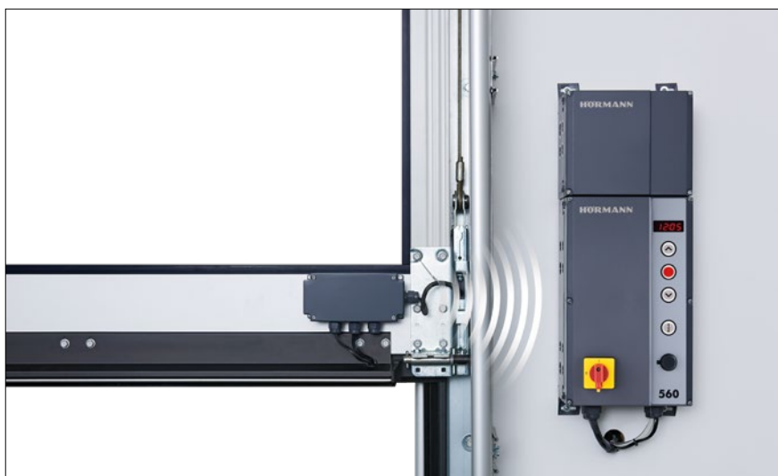
Unitate cu transmisie radio Pentru a transmite semnalele de pe canatul ușii prin Bluetooth către tabloul de comandă (fără cablu spiralat), se folosește o sursă de alimentare cu o baterie puternică; componente conectabile: senzori optici LE (low energy), barieră fotoelectrică externă VL 1-LE / VL 2-LE, baghetă 8k2, senzor cablu moale, contact pentru ușă pietonală înglobată, contact zăvor încuiere pe timp de noapte
