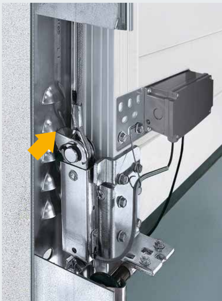
De vergrendelingshaak van de optilbeveiliging klikt bij het optillen automatisch vast.
