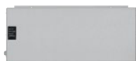
Nødstrømsanlæg til at overkøre strømsviger i op til 2 timer og op til 4 portcykluser; sikkerhedsudstyr, lyssignaler osv. forbliver i drift, LED-statusindikator, automatisk batteritest, overspændingsfilter, kapslingstype: IP 20 Mål: 560 x 235 x 260 mm (B x H x D),
