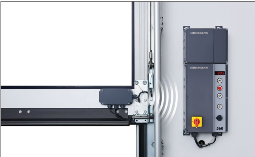
Trådløs overførselsenhed Til overførsel af signaler fra portbladet via bluetooth til styringen (ingen spiralledning), strømforsyning via et kraftigt batteri; komponenter, der kan tilsluttes: Optiske sensorer LE (low energy), medløbende fotocelle VL1-LE / VL2-LE, 8k2-liste, wiresikring, kontakt til gangdør, natrigelkontakt
