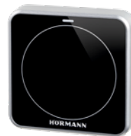
Transponderlüliti TTR 1000-1 Ühe funktsiooni jaoks, transponderlüliti või transponderkaardi abil, võimalik salvestada kuni 1000 võtit või kaarti
