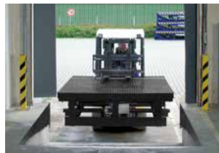
Naujos aukščio išlyginimo aikštelės naudojimas
