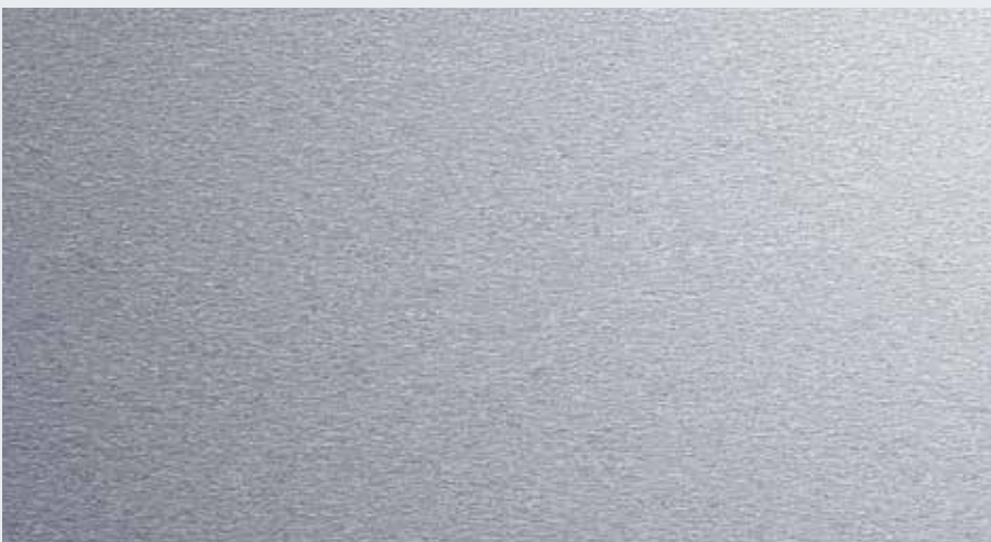
Acier inoxydable V2 A, 1.4301, grain 240
