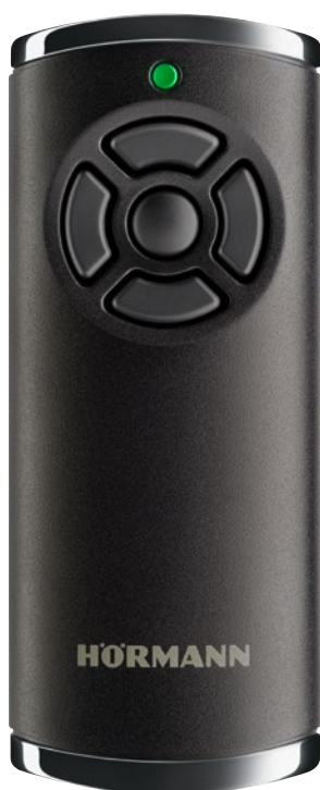
Zielona dioda LED na nadajniku HS 5 BS sygnalizuje, że brama jest zamknięta. Gdy brama jest otwarta, dioda LED świeci się czerwonym światłem (zdjęcie w skali 1:1).
