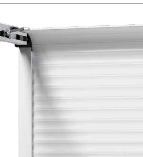
**STROPNA VRATA ROLLMATIC OD.** Stropna vrata koja štede prostor posebno su prikladna za garaže s vrlo malo nadvoja. Zavjesa vrata se vodi do stropa preko uskih vodilica. Zahvaljujući bočnoj montaži pogona koja štedi prostor RollMatic OD treba samo 60 mm nadvoja.
