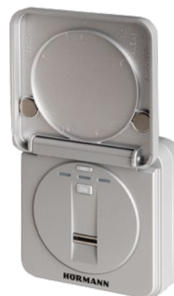
Безпроводний сканер відбитків пальців FFL 25 BS 2 функції, можна зберегти до 25 відбитків пальців, з відкидною кришкою, можливість прихованого або відкритого монтажу, пластмасовий корпус із покриттям у кольорі «білий алюміній» RAL 9006
