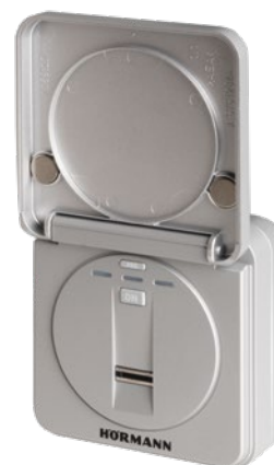
Радиуправляван скенер за пръстови отпечатъци FFL 25 BS за 2 функции, до 25 пръстови отпечатъка, със сгъваем капак, за скрит и открит монтаж, пластмасов корпус, лакиран в цвят бял алуминий RAL 9006
