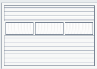
Motiv 480 Alu-rammer for seksjonsfylling med strekkgitter Ventilasjonsverrsnitt: 58 % av fyllingsflaten pr. ramme
