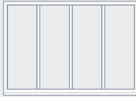
Motiv 400 (ramme) Ramme for fylling på monteringsstedet, innvendig liggende fylling gir et mangfold av individuelle muligheter til utforming.
