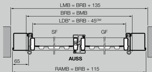
Dimensions standards des portillons indépendants à 1 vantail avec huisserie tubulaire de 65 mm
