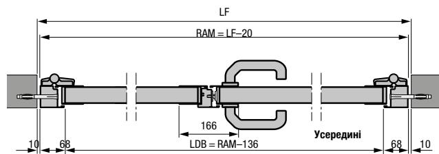
2-стулкові бічні двері з алюмінієвою блочною коробкою, тип профілю 2
