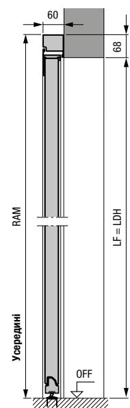
Бічні двері з алюмінієвою блочною коробкою, тип профілю 2
