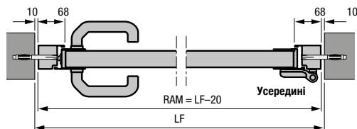
Бічні двері з алюмінієвою блочною коробкою, тип профілю 2
