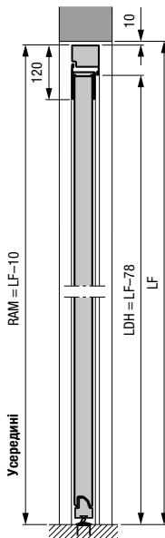
Бічні двері з алюмінієвою блочною коробкою, тип профілю 2
