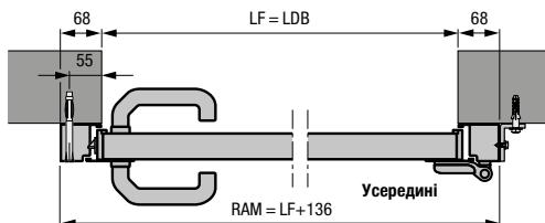
Бічні двері з алюмінієвою блочною коробкою, тип профілю 1
