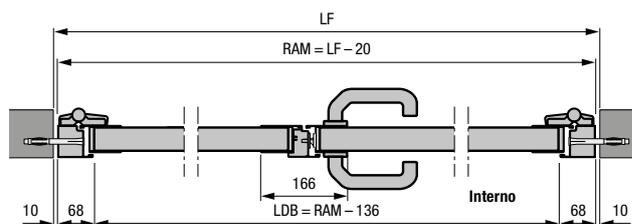
Porta laterale a 2 batt. con telaio tubolare in alluminio, profilo tipo 2
