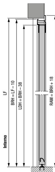
Porta laterale con telaio ad angolo in alluminio, profilo tipo 2
