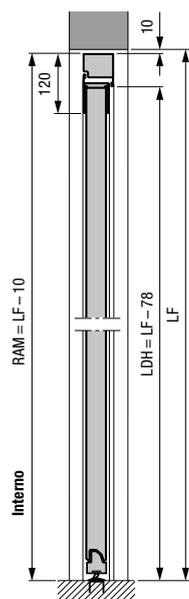
Porta laterale con telaio tubolare in alluminio, profilo tipo 2
