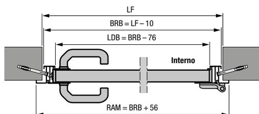
Porta laterale con telaio ad angolo in alluminio,
