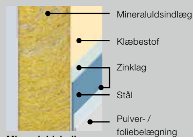
Mineraluldsindlæg (ekstraudstyr) giver bedre varmeisolering
