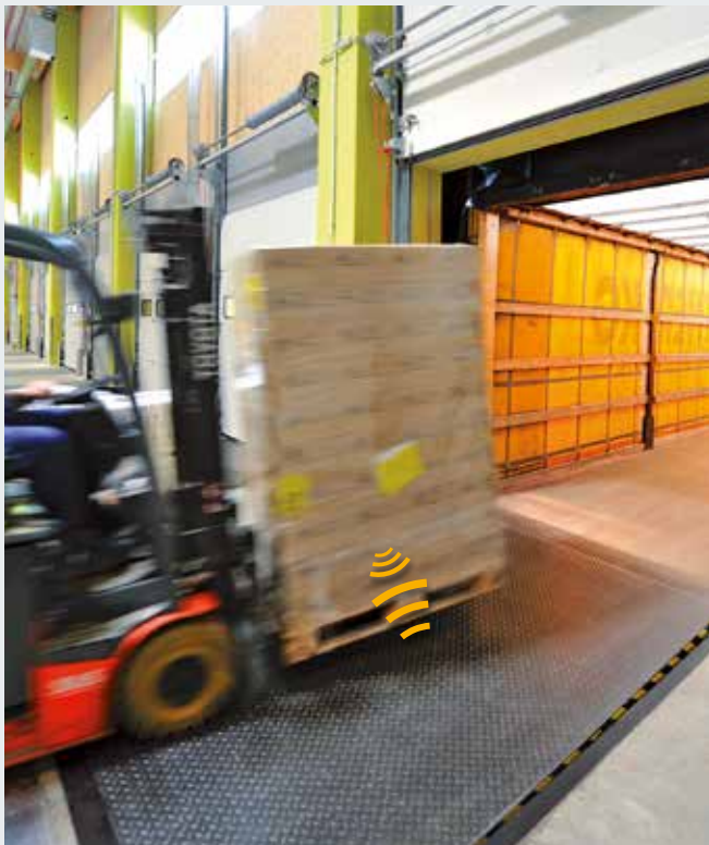
Автоматично регистриране на движения на стоките, просто при преминаване по товаро-разтоварната рампа.
