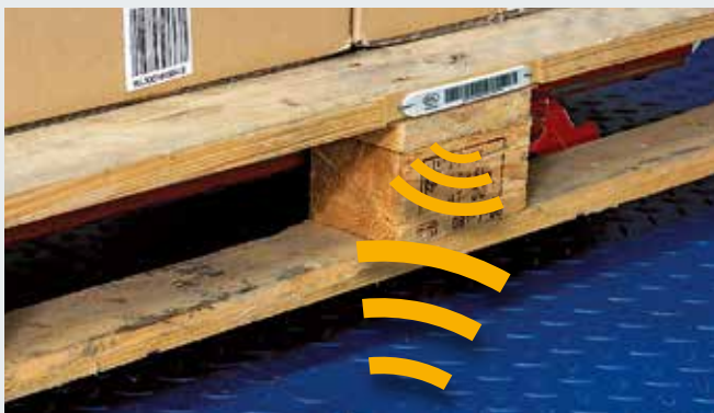
Надеждно прехвърляне на данни по най-краткия път между транспондер и четящо устройство с технологията RFID.
