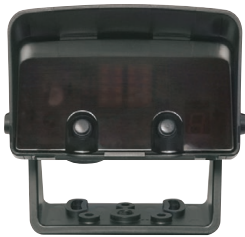
Radar détecteur de mouvement MWD-C Ouverture automatique rapide et ciblée de la porte, reconnaissance directionnelle, hauteur de montage max. 7 m, montage en zone de surgélation possible jusqu'à max. -22 °C, IP 65
