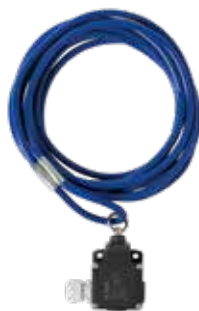
Potezni prekidač sa užetom Moguća je horizontalna ili vertikalna montaža, kućište od aluminijuma livenog pod pritiskom, IP 65, dužina užeta 4 m
