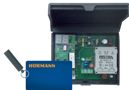
Безконтактний кодовий замок TTR 1000-1 1 функція, за допомогою ключа безконтактного кодового замка чи транспондерної картки; можна зберегти до 1000 ключів чи карток
