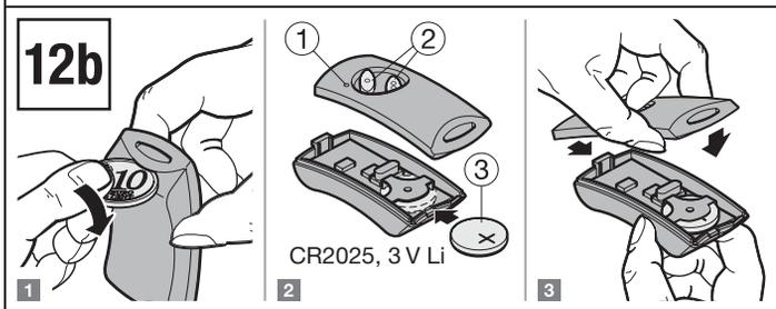
**4.2 Colocar/cambiar las pilas**
