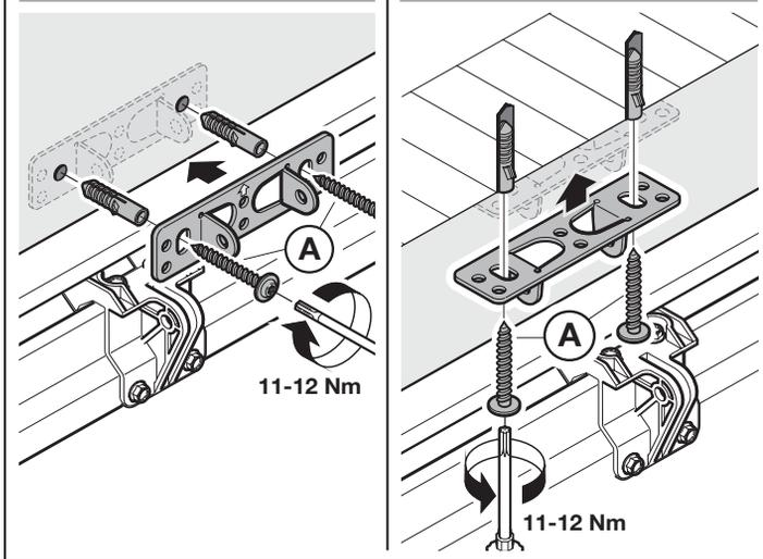
**3.4 Führungsschiene montieren**
