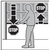
1. Halten Sie das Tor mit beiden Händen an, während es **zufährt**. Die Toranlage muss anhalten und den Sicherheitsrücklauf einleiten.
