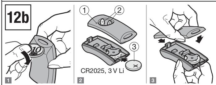
**4.2 Vložení / výměna baterií**
