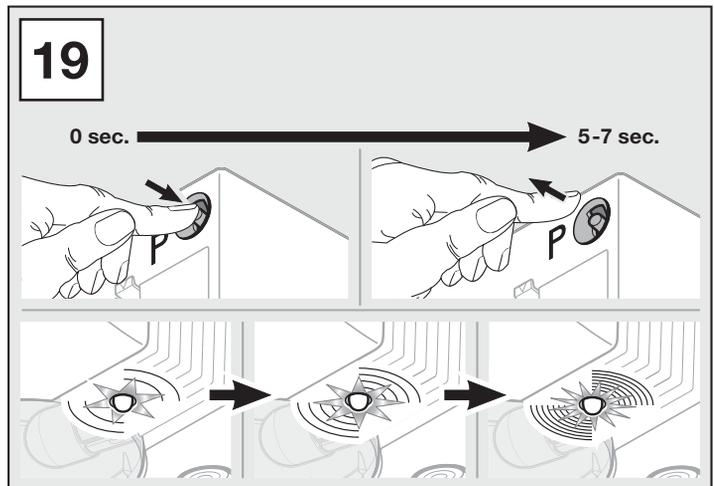
**11.3 Apagar as posições de memória de radiofrequência**
