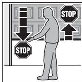
1. Přidrže vrata při **zavírání** oběma rukama. Vratové zařízení se musí zastavit a zahájit bezpečnostní zpětný chod.
