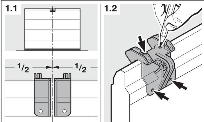
**3.2 Montaggio dell'angolare per motorizzazione**
