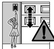
absoluut buiten het bereik van kinderen worden gemonteerd! Waarschuwbordjes tegen vastklemmen moeten permanent worden aangebracht op een opvallende plaats of in de nabijheid van een vast geïnstalleerde bediening voor de aandrijving. Het plafond van de garage moet stevig genoeg zijn om een veilige bevestiging van de aandrijving te verzekeren. Indien het plafond te hoog of te zwak is, moet de aandrijving worden bevestigd aan bijkomende steunbalken.
