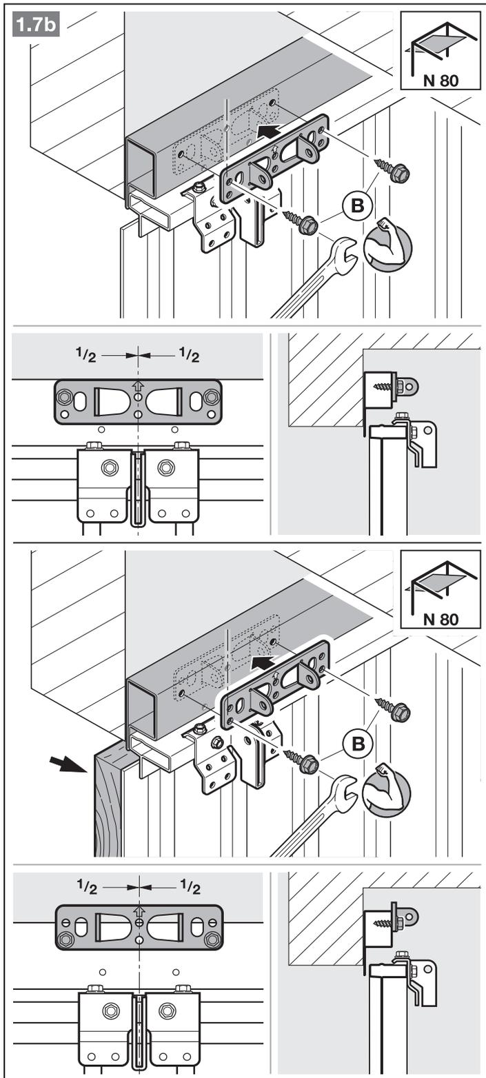
3.4 Монтаж направляющей шины
