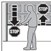
1. Přidržte vrata při **zavírání** oběma rukama.
