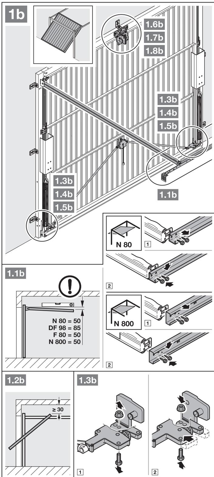
5. Odłączyć mechaniczne ryglowania bramy (patrz rys. 1.4b / 1.5b).
