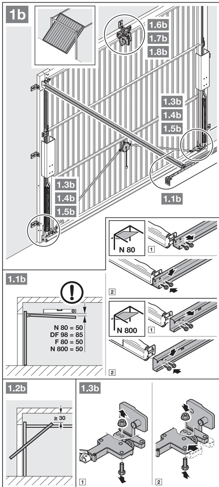
5. Mechanická zajištění vrat vyřadte z provozu (viz obr. 1.4b / 1.5b).
