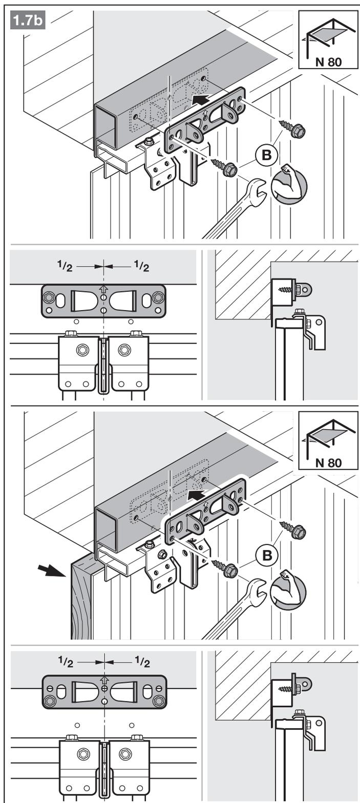
3.4 Montáž vodící kolejnice
