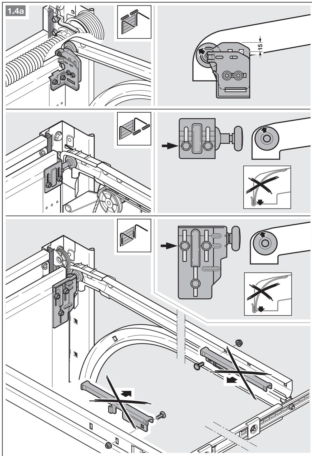
3. U sekčních vrat se středovým zámek umístíte kloub překlady a unášecí úhelník mimo střed (max. 500 mm).
