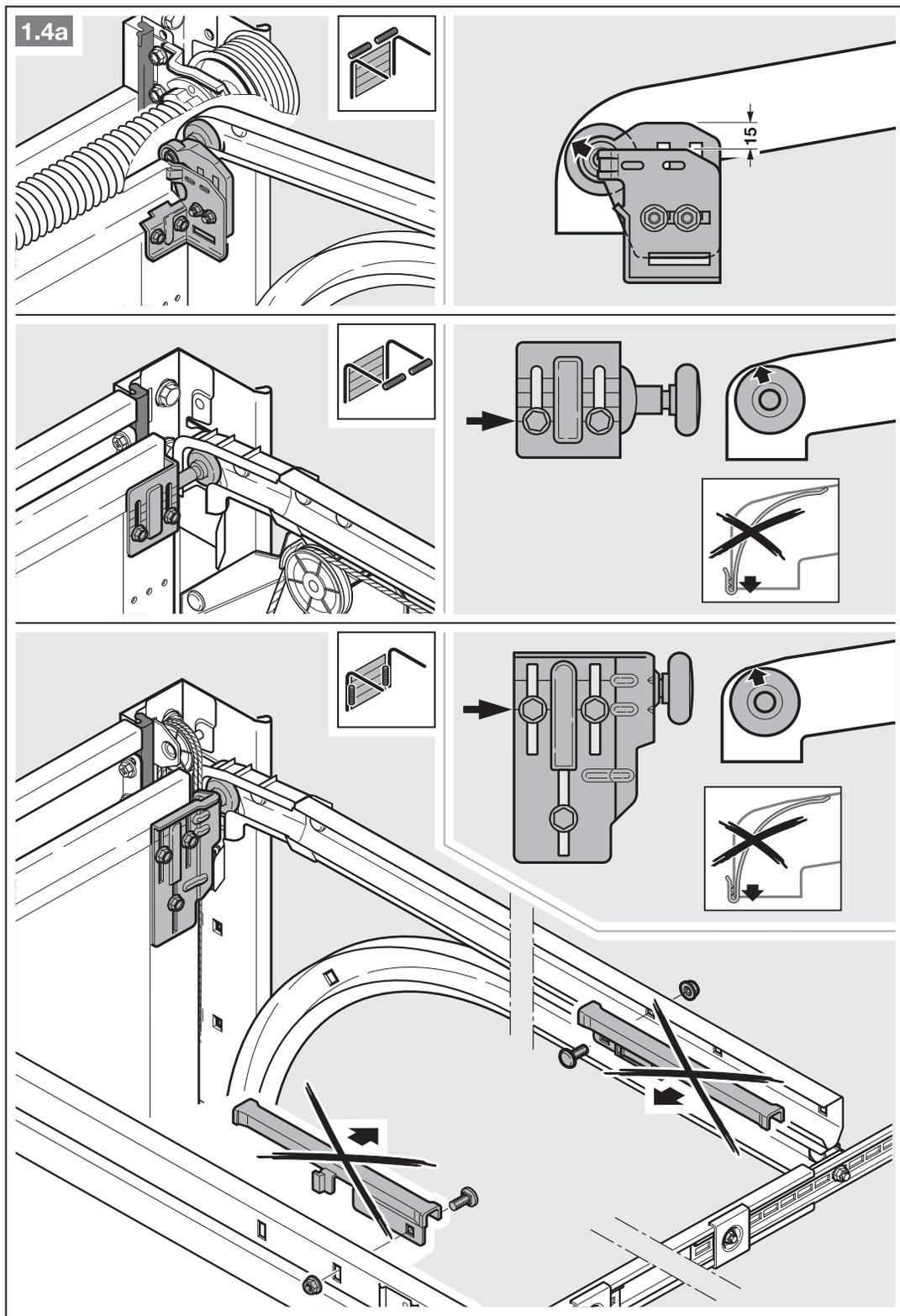
3. Konsolę nadproża i kątownik zabieraka w bramach segmentowych wyposażonych w środkowe zamknięcie należy mocować w odległości maksymalnie 500 mm od osi bramy.
