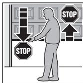
1. Přidržte vrata při **zavírání** oběma rukama. Vratové zařízení se musí zastavit a zahájit bezpečnostní zpětný chod.
