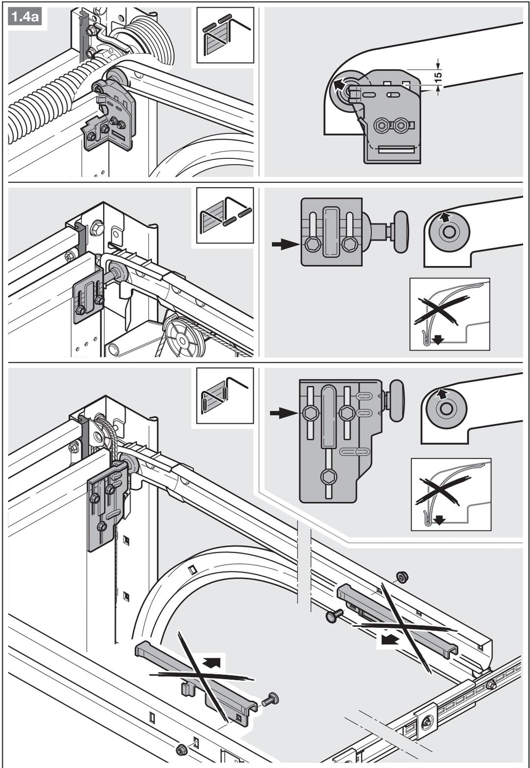
3. Разместите на секционных воротах с затвором, установленным по центру ворот, шарнир перемены и поводковый угольник с отклонением от центральной оси (макс. 500 мм).
