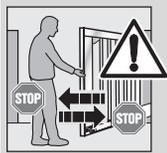
Weisen Sie alle Personen, die die Toranlage benutzen, in die ordnungsgemäße und sichere Bedienung ein. Demonstrieren und testen Sie die mechanische Entriegelung sowie den Sicherheitsrücklauf. Halten Sie dazu das Tor während des Torzulaufes mit beiden Händen an. Die Toranlage muss den Sicherheitsrücklauf einleiten.
