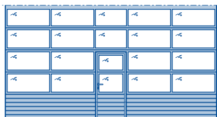
Porte sectionnelle APU 67 Thermo avec portillon incorporé à seuil plat
