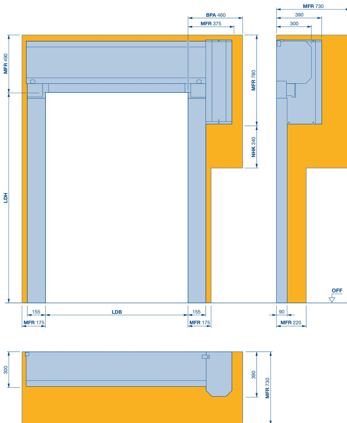
**BPA** Encombrement nécessaire pour le montage et le démontage de la motorisation
