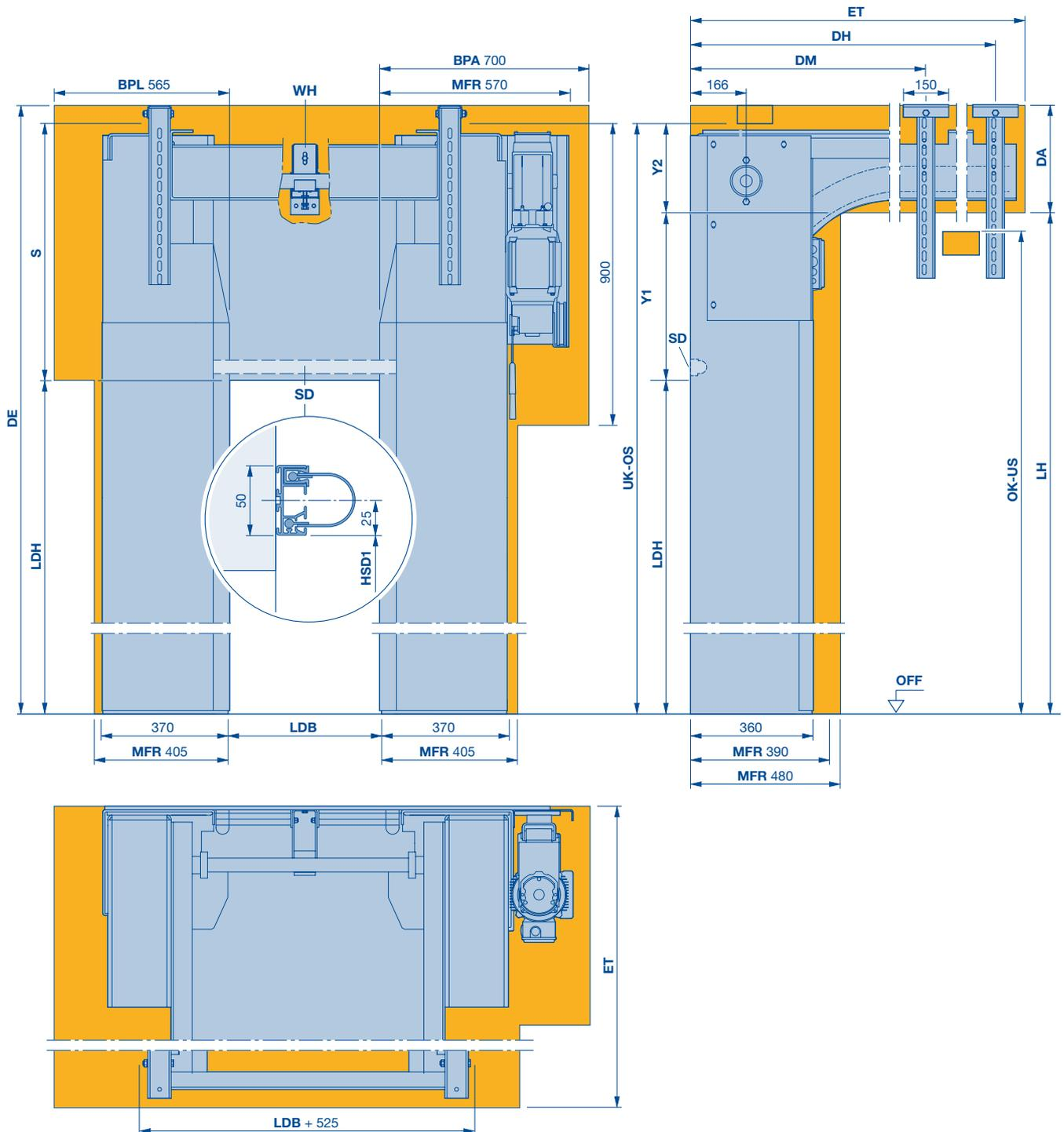
**BPA** Encombrement nécessaire pour le montage et le démontage de la motorisation
