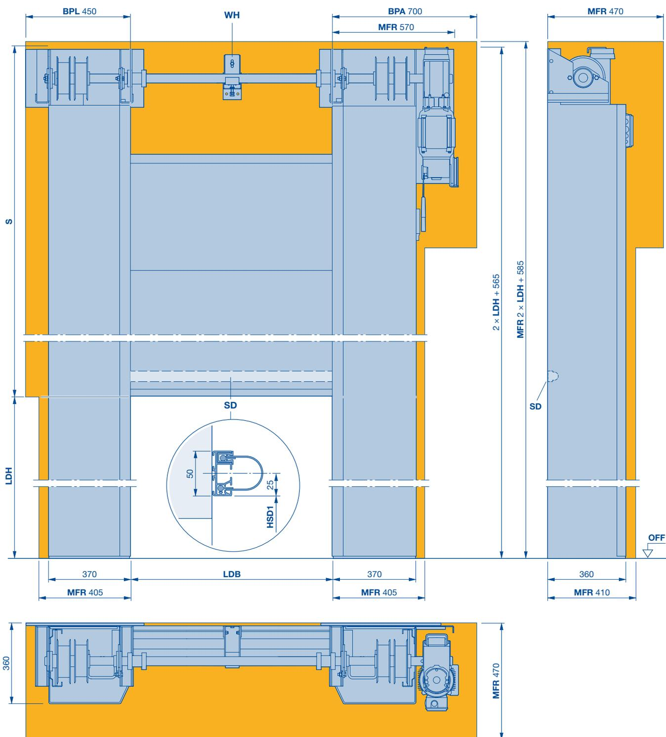
**BPA** Encombrement nécessaire pour le montage et le démontage de la motorisation
