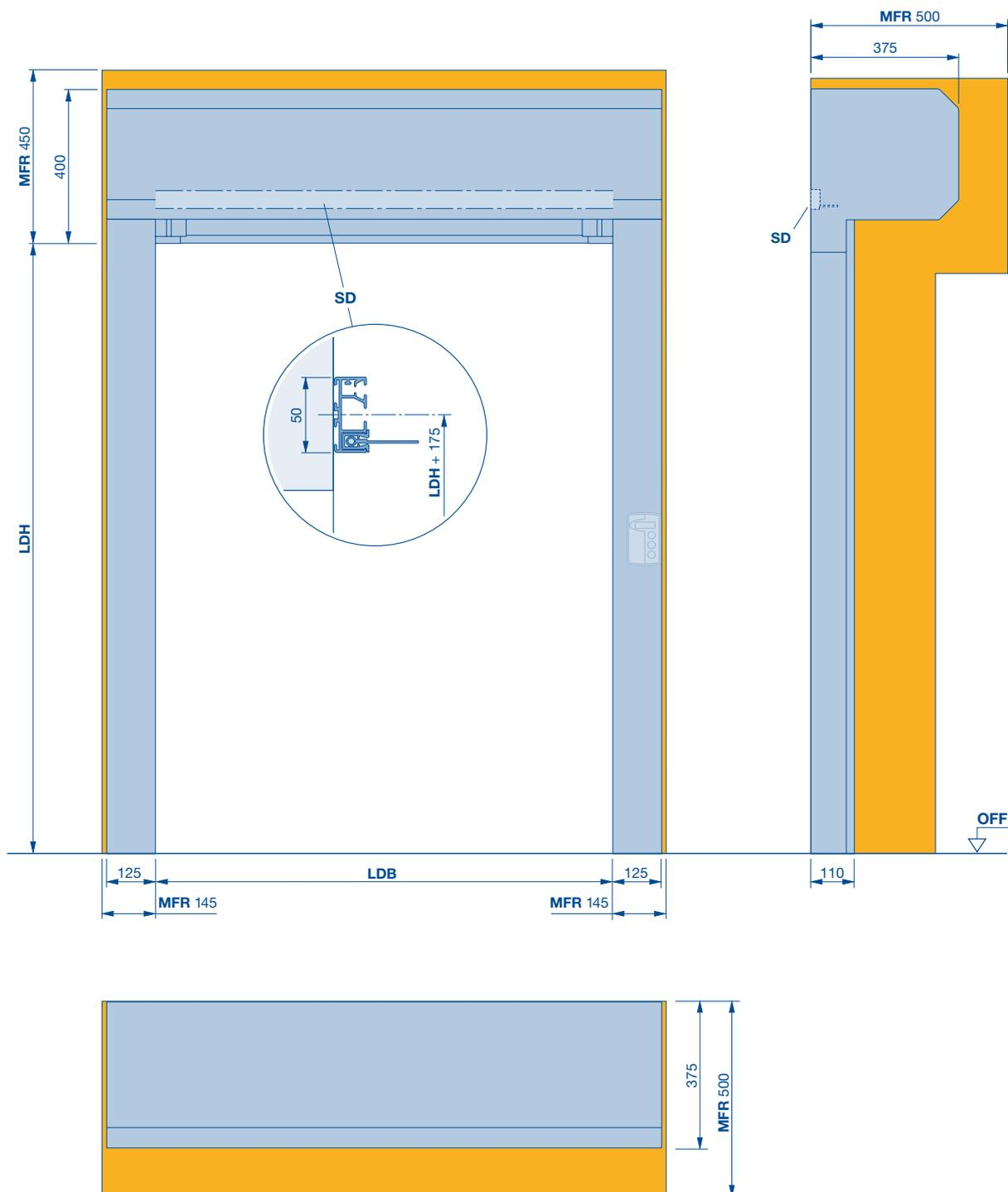
**BPA** Encombrement nécessaire pour le montage et le démontage de la motorisation
