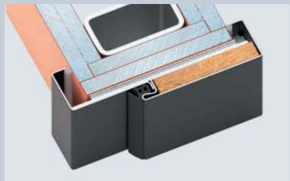
3. Gegenzargen-Profil der Zarge durch die Dichtungsnut mit Profil verschrauben und mit der Türdichtung überdecken
