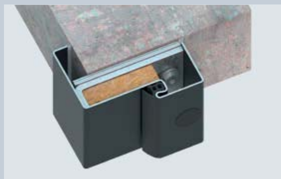
3. Anschlussfugen versiegeln und Dübel-Befestigungslöcher abdecken
