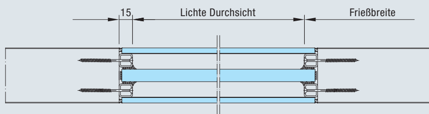
Flächenbündige Rechteckverglasung für den Reinraumbereich (nur bei MZ und EI 2 30* Türen möglich)
